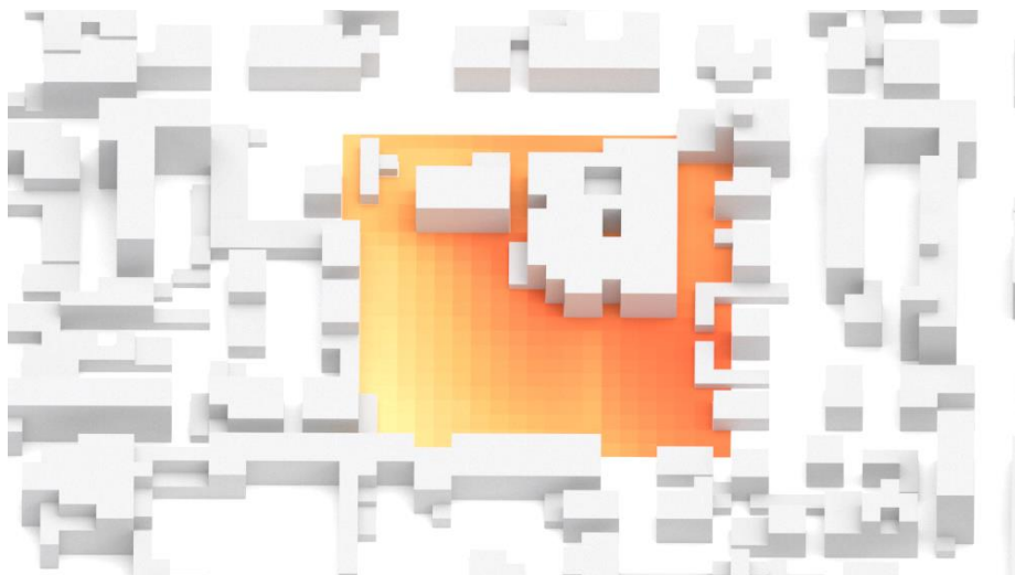
Fig. 85 Focus 3, Rappresentazione tridimensionale delle temperature ad 1,5 metri dal suolo, Adattamento avanzato, ore 18:01-19:00
