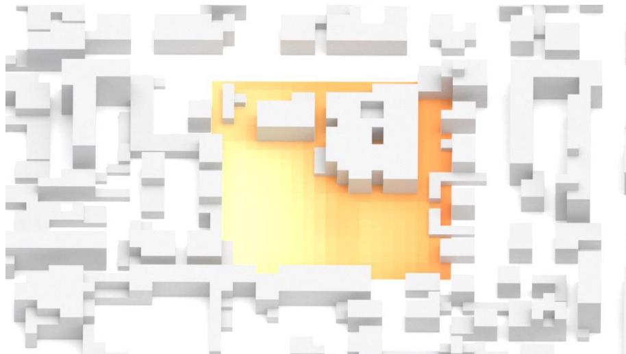
Fig. 84 Focus 3, Rappresentazione tridimensionale delle temperature ad 1,5 metri dal suolo, Adattamento migliorativo, ore 18:01-19:00
